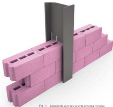
Fig. 14 - Ligação da alvenaria a uma estrutura metálica
