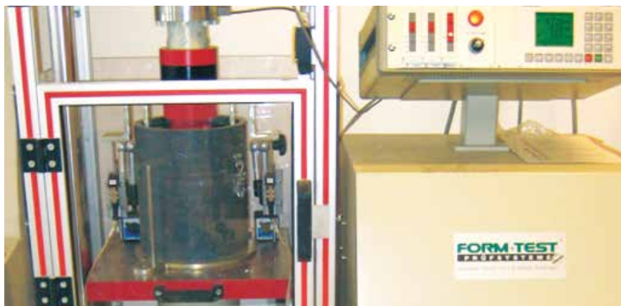
Figura 12 Execução do ensaio de fluência sob compressão no laboratório do SINTEF, na Noruega.
