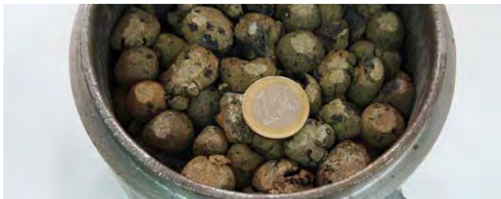
Figura 11 Aspecto de um provete de Geo Leca® após ensaio de resistência ao esmagamento.
