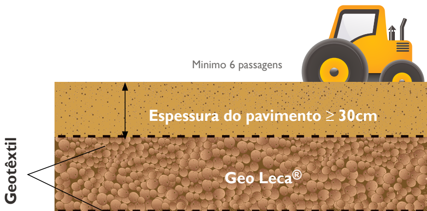
Figura 33 Espessura mínima recomendada para a compactação da camada granular imediatamente acima do aterro com Geo Leca® e número mínimo de passagens do cilindro compactador.
