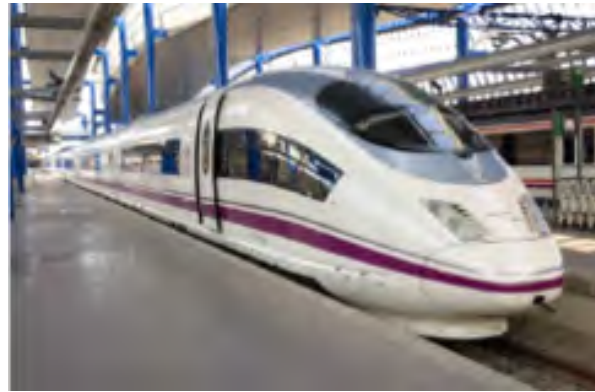
Siemens S-103: 32 ejes en 16 bogies
