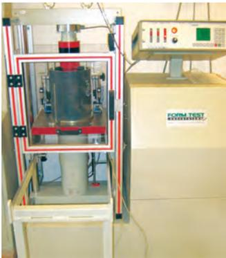
Figura 12 – Execução do ensaio de fluência sob compressão no laboratório do SINTEF, na Noruega
