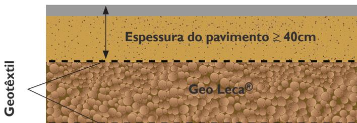
Figura 26 – Espessura mínima de pavimento rodoviário sobre um aterro com Geo Leca®
