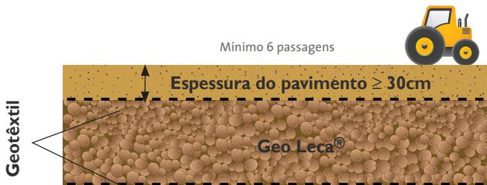
Figura 33 – Espessura mínima recomendada para a compactação da camada granular imediatamente acima do aterro com Geo Leca® e número mínimo de passagens do cilindro compactador
