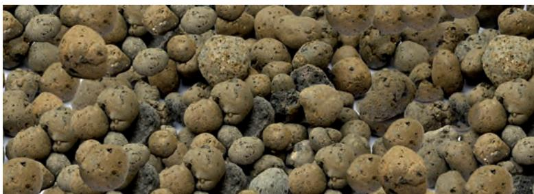
A utilização de Geo Leca® permite evitar o desmonte de uma quantidade significativa de maciços rochosos. Cada m<sup>3</sup> de argila utilizado no fabrico de Geo Leca® evita o desmonte de cerca de 5 m<sup>3</sup> de rochas para a produção de agregados britados, minorando os impactos sobre a paisagem. Como alternativa ao uso de areias naturais,
