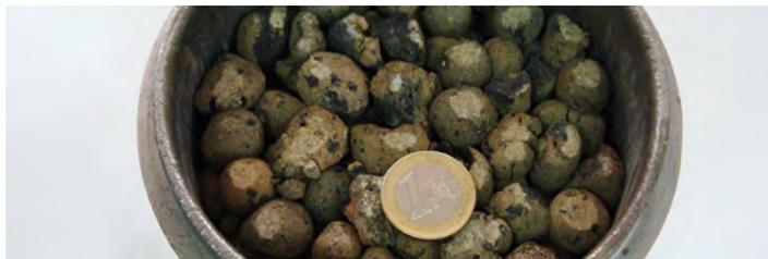
Figura 11 – Aspecto de um provete de Geo Leca® após ensaio de resistência ao esmagamento
