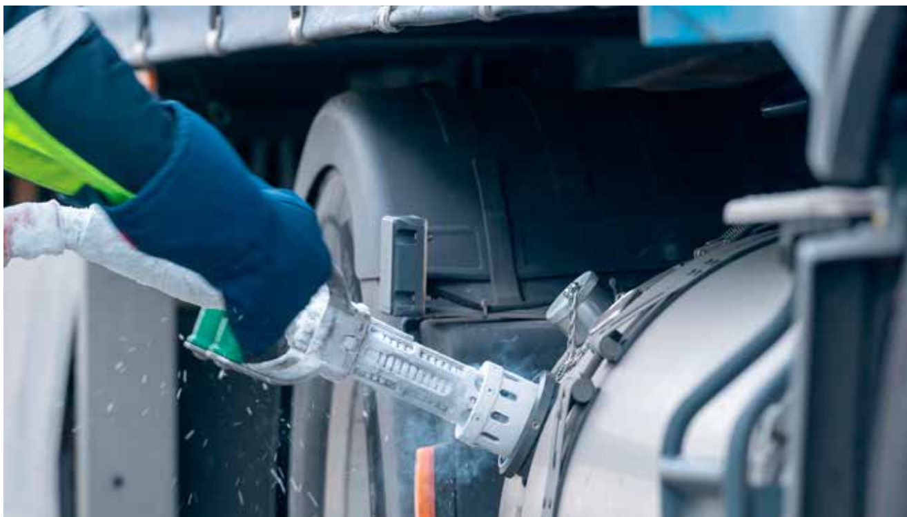
Os camiões são abastecidos com Gás Natural Liquefeito
