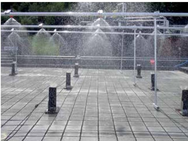
**O Klima 2050** centra-se em soluções com elevada capacidade de retenção de água e resistência a testes extremos. Aqui é testada a capacidade de retenção de um pavimento permeável com uma subcamada de Leca®. Foto: Tore Kvannd, NTNU
